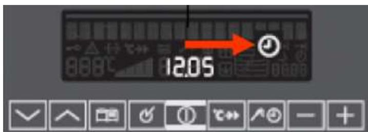
Lorsque le four est à l'arrêt et si le symbole
